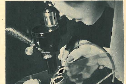
La saldatura dei fili di quarzo per un giogo di bilancia si ottiene per fusione mediante un cannello.
