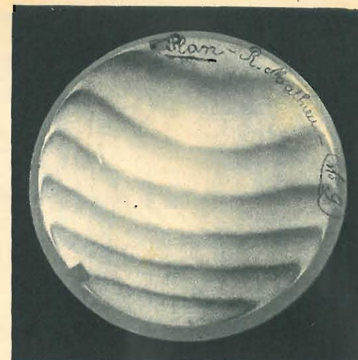
Fra la lente e il suo calibro il cuneo d'aria interposto fa comparire 13 frange; il suo spessore è quindi di 3,25 \mu (0,25 per frangia); a destra, una prima lavorazione riduce lo spessore a 1,5 \mu (6 frange).
