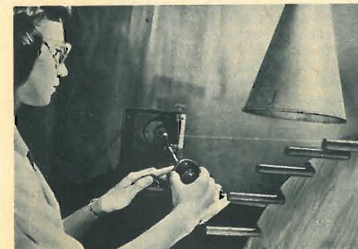
Il filo di quarzo ottenuto dal bastoncino fuso, viene trascinato da una ruota in rapido moto che lo stira.
