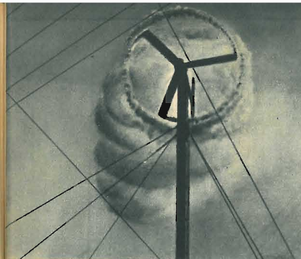
Fotografie della scia dell'elica di un motore a vento, prese con vento di 4,5 m/sec, ottenute disponendo alcune bombe fumogene sotto il tubo porta-elica del medesimo motore a vento con pale cave.
